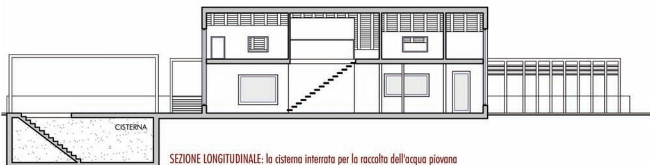
SEZIONE LONGITUDINALE: la cisterna interrattata per la raccolta dell'acqua piovana
